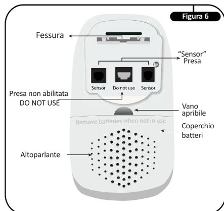
**IMPORTANT:** Al fine di evitare danneggiamenti ai cavi del sensore assicurarli sotto il materasso assicurandoli con la fascetta in dotazione. Non lasciarli in vista o facilmente raggiungibili.
